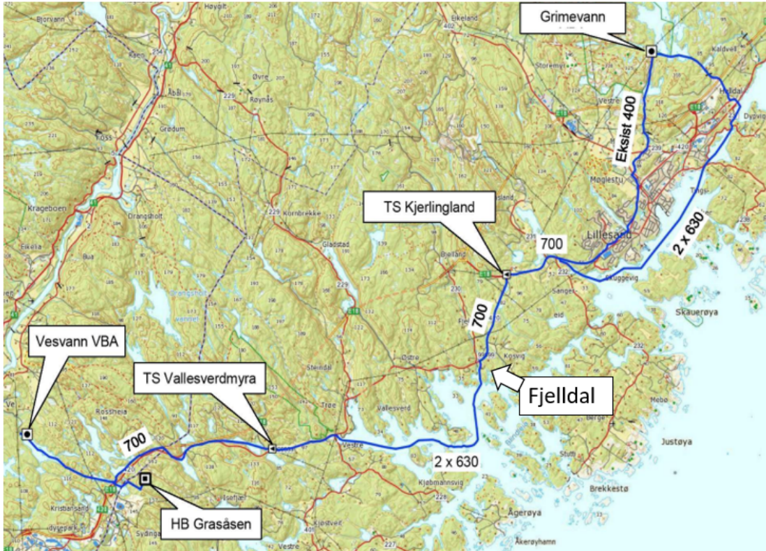
Figur 1: Kart som viser ledningsstrek og trykkøkningsstasjoner (TS). Figur hentet fra Aprova sin rapport «Reservevann Lillesand – Kristiansand» (2016).
