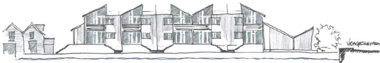
Oppriss av nord fasaden med 2. etasjers høyde
