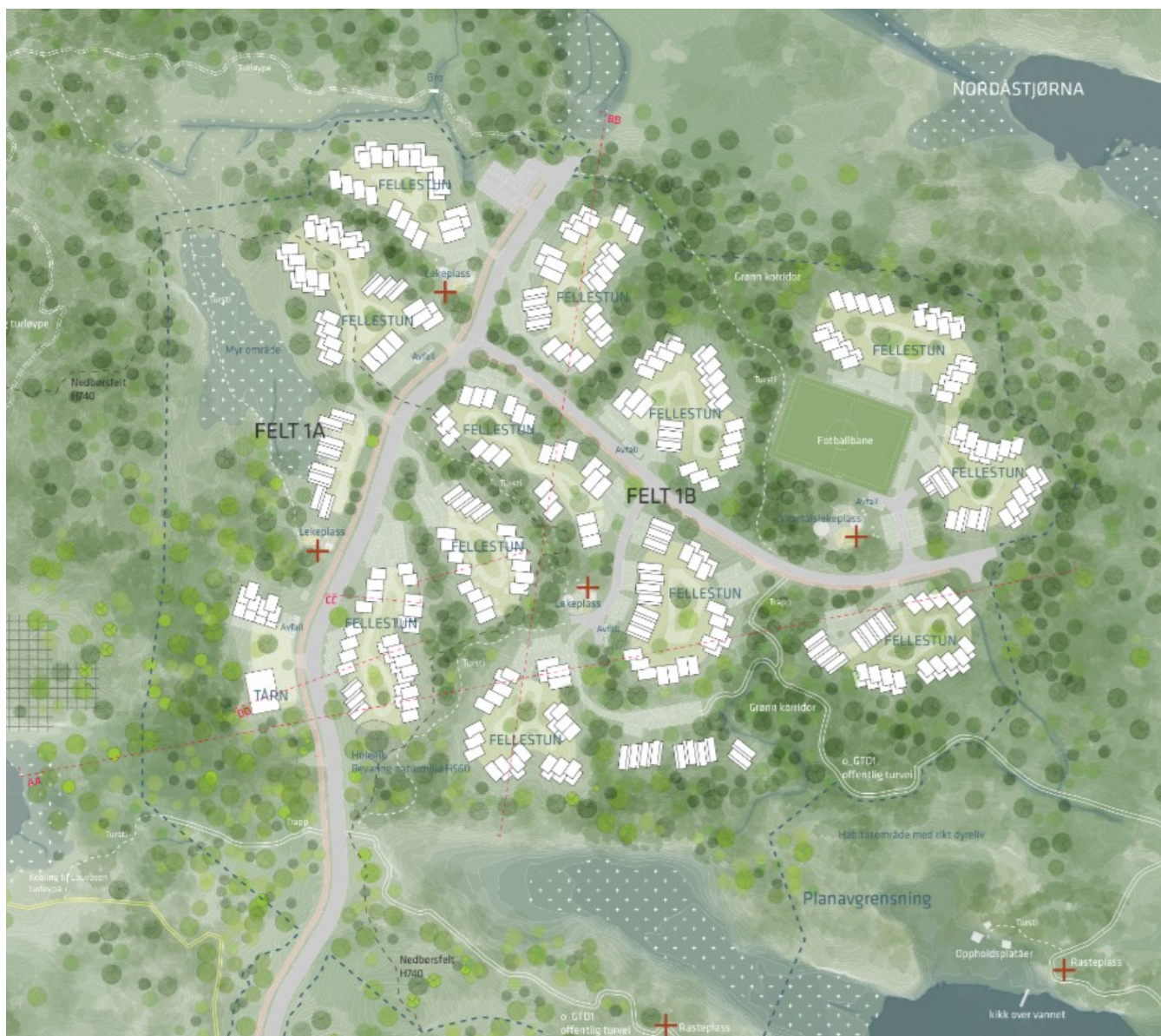
Illustrasjonsplan som viser tun løsninger for bebyggelsen, hvor bilene parkerer utenfor byggeområdene.
