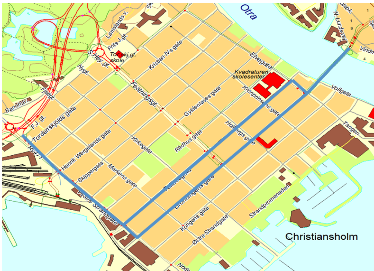
Fig. 6.12 Skisse over alternative hovedtraseer for buss gjennom Kvadraturen. Et alternativ er å ha all busstrafikk i Tollbodgata. Et annet alternativ er å ha enveiskjøring med både busser og privatbiler østover i Tollbodgata og vestover i Dronningensgate.
