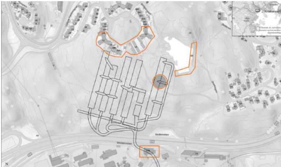
Figur 8 - Bygningsmasse som skal undersøkes iht. NS 8141-4:2021 (hentet i fra planbeskrivelsen)
