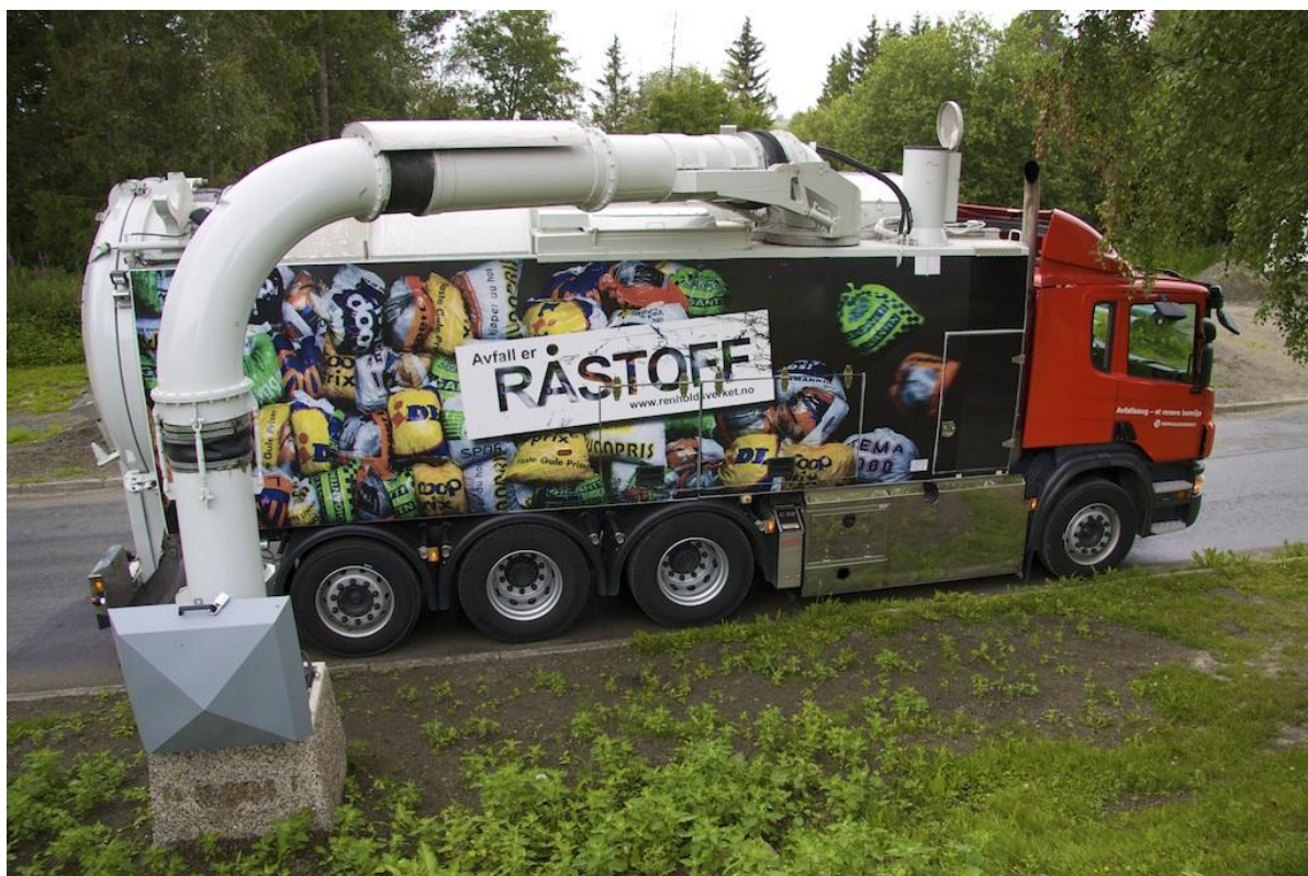
Figur 6.1.3 Sugebil for mobilt avfallssug. Dokkingstasjon i forkant. (Kilde: www.envac.no)
