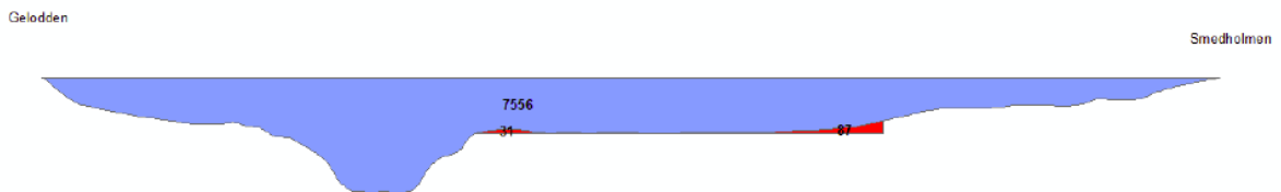
Tverrsnitt av Topdalsfjorden, hvor røde arealer viser hva som skal utdypes. Tall i m².
