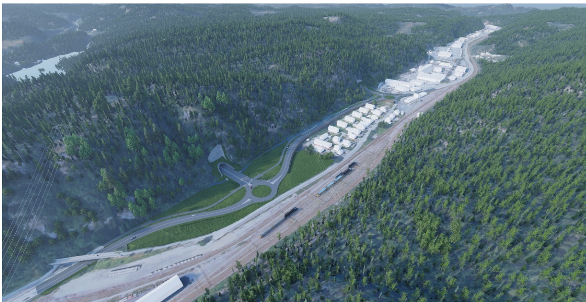
3D bilde av veimodell i Dalane med 2 nye rundkjøringer og tunellinnslag til rampekryss.
